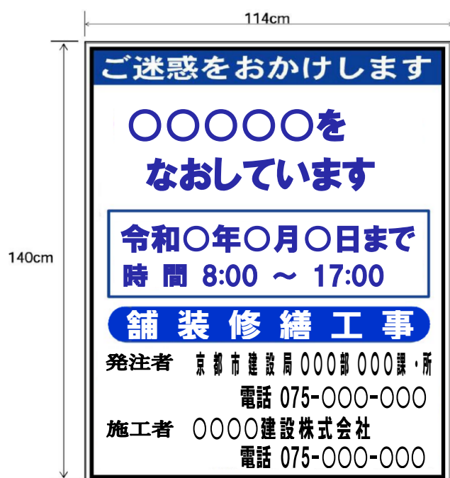
(例) 道路工事の標示板
