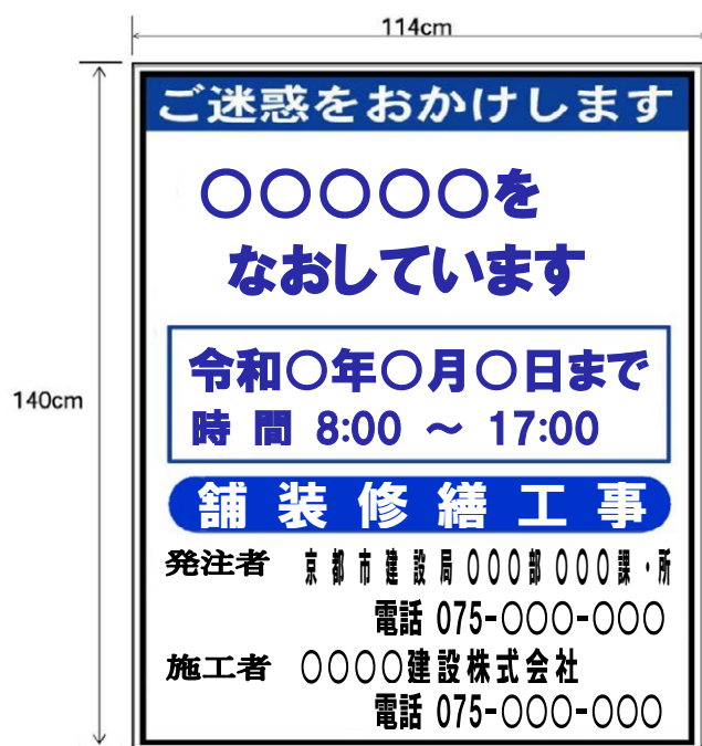
(例) 道路工事の標示板
