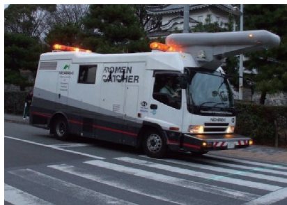
舗装のひび割れ等を測定する路面性状調査
