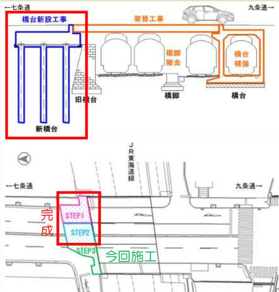
皆様の御協力もあり、ステップ1に続き、ステップ2部分の橋台（今熊野橋を支える土台）も完成しました。残りの西側のステップ3部分を造ると、新橋台が完成し、その後は橋の架替工事に移ります!
