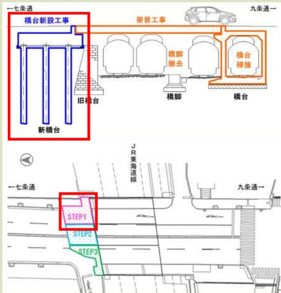
皆様の御協力もあり、ようやくステップ1(※の橋台(今熊野橋を支える土台)が完成しました。引き続きステップ1と同様にステップ2及び3の橋台を築造していきます。
