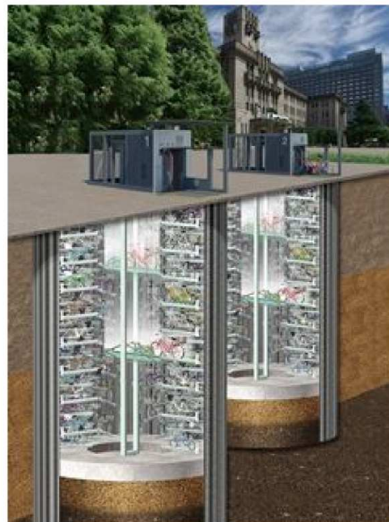
市役所前広場機械式駐車場
