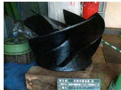
※ポンプを分解してインペラ(羽根車)を取り出し、鋸を落として表面を平滑に研磨・再塗装することで、長寿命化を図りました。また、ポンプを分解することで、普段は点検できない部分に異常がないか、詳細な調査ができます。
