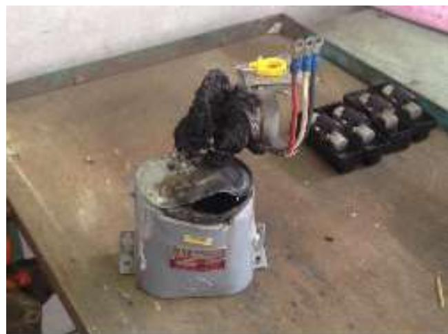
（破損すると排水機に電源供給ができない。）
