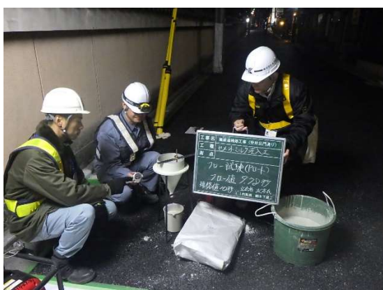
セメントミルクの品質管理 (フロー値の測定)
