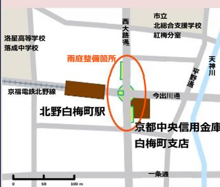
【雨庭とは?】雨水を一時的に貯めて、ゆっくりと地下に浸透させるための緑地で、近年、多く発生するゲリラ豪雨への対応としても注目されています。京都市では市内各地の街路樹帯を活用して、全国に先駆けて整備を進めています。
