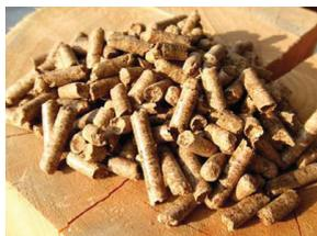
木質ペレットは，新たなエネルギー源となるだけでなく，再生可能な燃料であるため将来にわたって安定して利用できる。さらに，木質ペレットは，燃やしたときに発生する二酸化炭素と，木が生長する過程で吸収した二酸化炭素が同じ量であると考えられ，大気中の二酸化炭素の増減には影響を与えない，いわゆるカーボンニュートラルな地球にやさしい燃料である。
