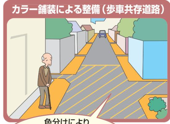
色分けにより車両のスピードを抑制し歩行者の安全を確保します。
