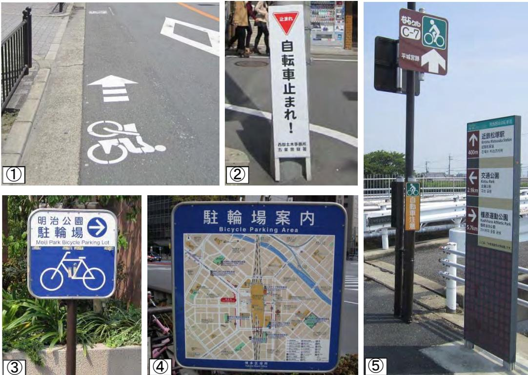
①自転車走行位置の明示の例      ②自転車への一時停止の注意喚起の例
