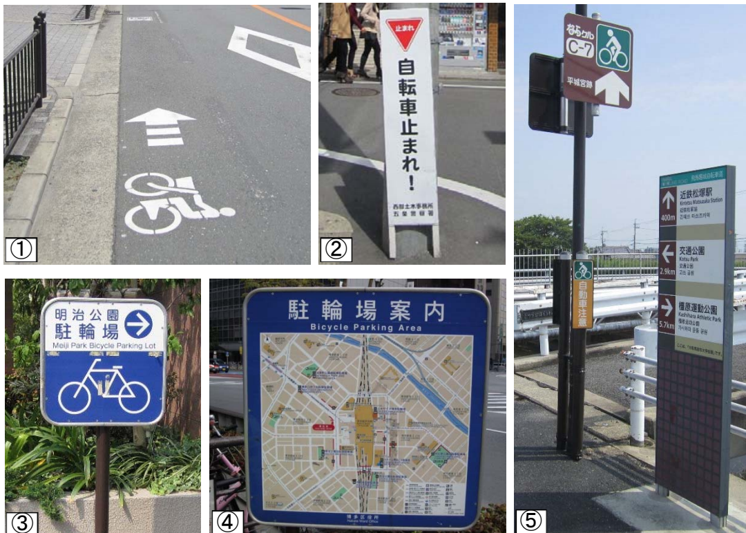
①自転車走行位置の明示の例 ②自転車への一時停止の注意喚起の例 ③④駐輪場への案内の例 ⑤自転車観光ルートのご案内の例
