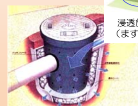
雨水を土中に浸透させる
