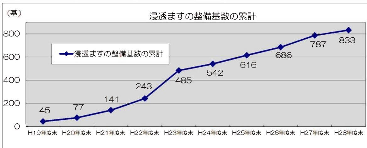
標準的な条件下で上記の浸透ます全てが整備がされていると仮定すると、浸透ますの設計浸透量（浸透施設の持つ浸透可能量）は約141.6m<sup>3</sup>/hとなる。これは、これまでに整備された浸透ますが、1時間あたりドラム缶 708.0 本分に相当する雨水を浸透できるだけの機能が備わっていることを示す。
