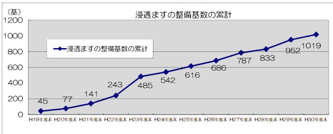
標準的な条件下で上記の浸透ます全てが整備がされていると仮定すると、浸透ますの設計浸透量（浸透施設の持つ浸透可能量）は約173.2m<sup>3</sup>/hとなる。これは、これまでに整備された浸透ますが、1時間あたりドラム缶 866.0 本分に相当する雨水を浸透できるだけの機能が備わっていることを示す。
