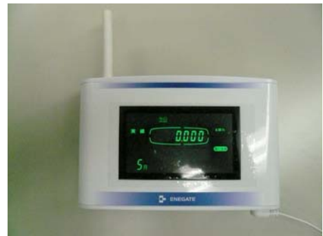
【省エネナビ】家庭全体の電気消費量を測る機器で、プレーカーに取り付けたセンサーから電波を飛ばして、居間などで状況が一目でわかります。
