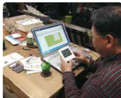
「節電モニター」では、1時間当たりの電気使用量と電気料金がリアルタイムで表示されます。リビング等で電気使用量を確認することができます。
