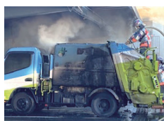
ごみ収集車の荷台での火災
