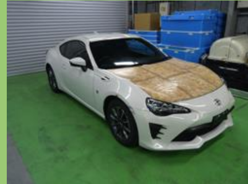
エンジンフード（エポキシ樹脂+CNFシート） 製作：金沢工業大学
