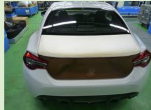
トランクリッドアッパー（CNF100%） 製作：利昌工業(株) トランクリッドロアー（PA6-CNF5%） 製作：ダイキョーニシカワ(株)
