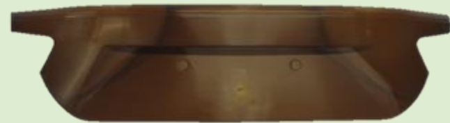
トランクリッド ロア* ナイロン6(PA6)-CNF(5%) 【NEDOからの提供品を使用】
