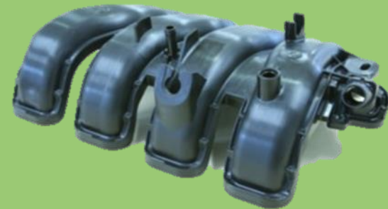
インテークマニホールド* (吸気部品) ナイロン6(PA6)-CNF(15%) 【NEDOからの提供品を使用】
