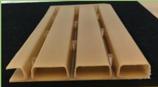
エンジンフード（ボンネット） ポリプロピレン(PP)+CNF(10%)
