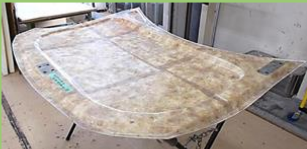
エンジンフード (ボンネット) エポキシ樹脂+CNF
