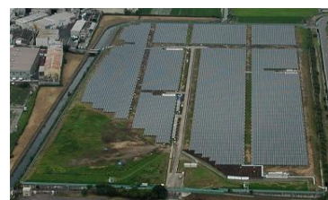
発電電力量は、一般家庭約 1,000 世帯分の年間消費電力量に相当する約 420 万 kWh / 年(見込み)
