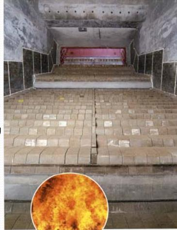
ストーカ炉内部・燃焼状態
