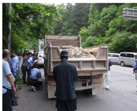
燃料に不正軽油使用の有無を確認するため、燃料を抜き取っているところ
