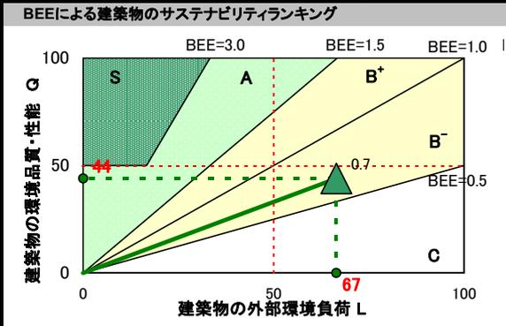
BEE =  $\frac{\text{建築物の環境品質・性能 } Q}{\text{建築物の外部環境負荷 } L}$
