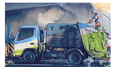
京都市のごみ収集車の火災被害状況
