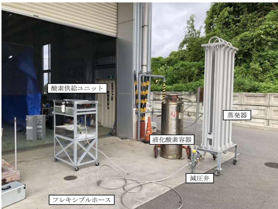
※ 写真は、液化酸素容器の液化酸素を蒸発器を用いて常温ガスに気化させ、減圧弁で圧力を調整した上で、フレキシブルホースを用いて酸素供給ユニット（複数患者への供給が可能）に接続している（事業者の協力の下、説明用に配置したもの）。患者安全に十分留意しつつ、日本産業規格（JIS 規格）外の緊急的な対応を行うことを想定。
