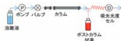
図1 イオンクロマトポストカラム法の配管
