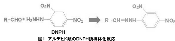
図1 アルデヒド類のDNPH誘導体化反応
