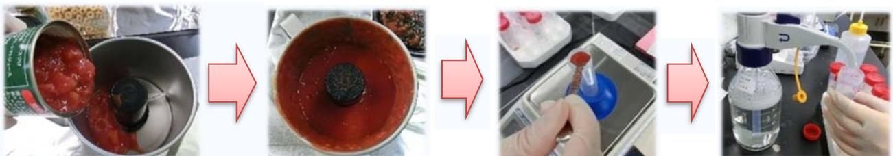
続いて、機械で一晩振り混ぜた後、抽出した液をアレルギー反応検出試薬の入ったプレートに入れます。アレルギーと反応した場合には黄色に変色します。この黄色の変色の度合いを機械で測定することにより、食品に含まれているアレルギーの濃度がわかります。
