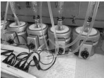
図4 クロロベンゼンによる蒸留作業
