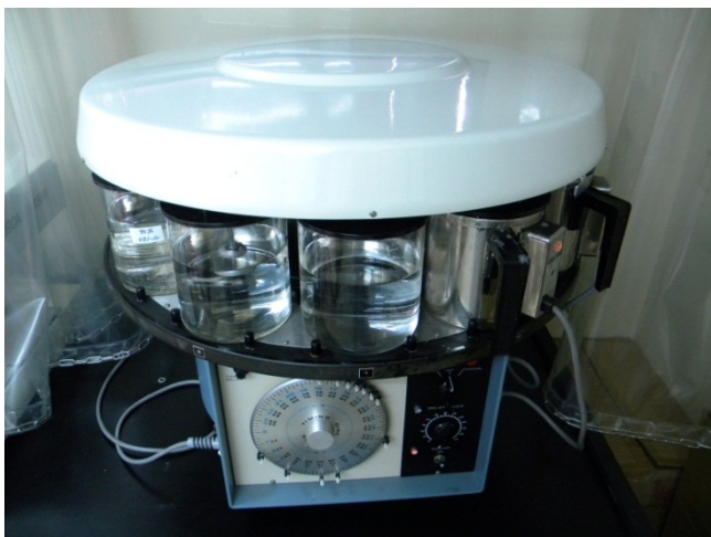
京都市の自動包埋装置です。 18時間で自動的にパラフィン浸透までやってくれます。
