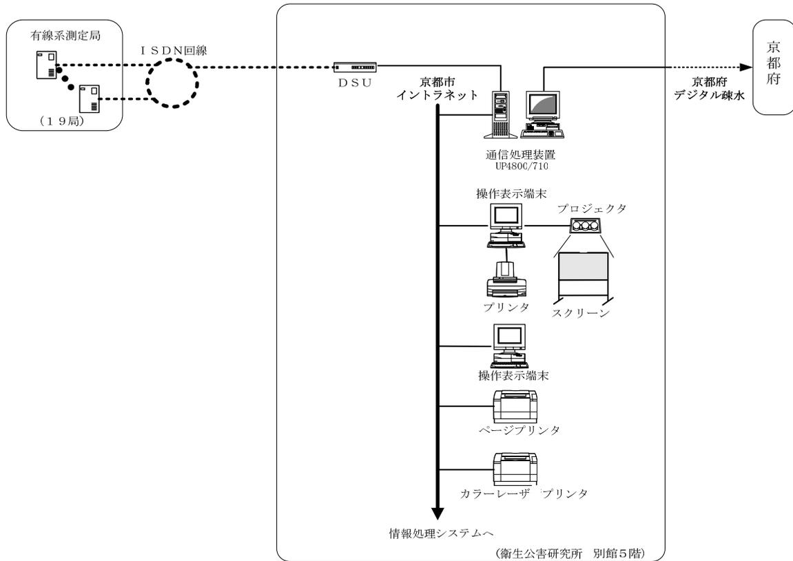
図 2-8-1 大気汚染常時監視テレメータシステム系統図 (平成19年度)
