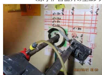
1号機 原子炉容器外の試料採取状況
