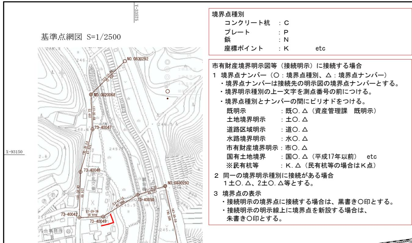
基準点網図の辺長は、球面距離とする。
