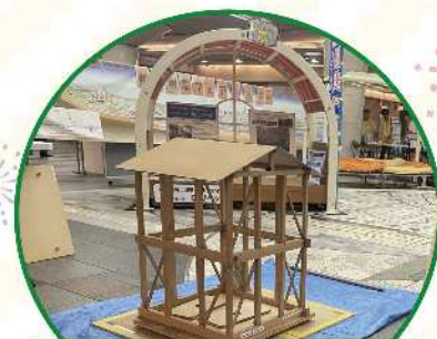
木造住宅倒壊模型
