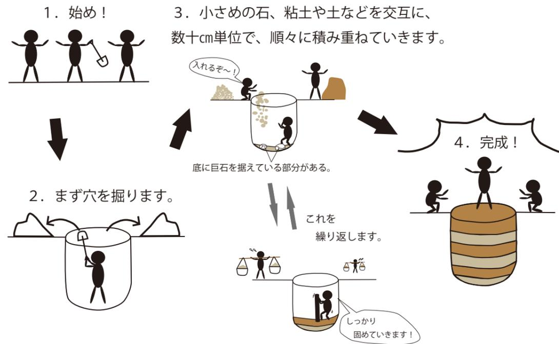
図9：壺地業作業工程模式図
