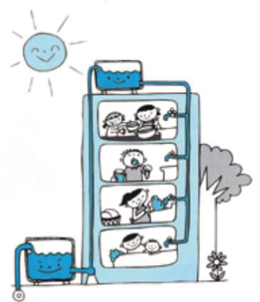
私たちが使用している水道水には、本管から直接給水する直結方式と、いったん受水槽にためてから給水する受水槽方式があります。一般的に、水圧の不足する3階以上の建物や大量の水を使用する施設の飲用水は、受水槽方式で給水されています。受水槽方式では、設備の点検管理や検査などを怠ると、重大な水質汚染事故を引き起こすことがあります。
