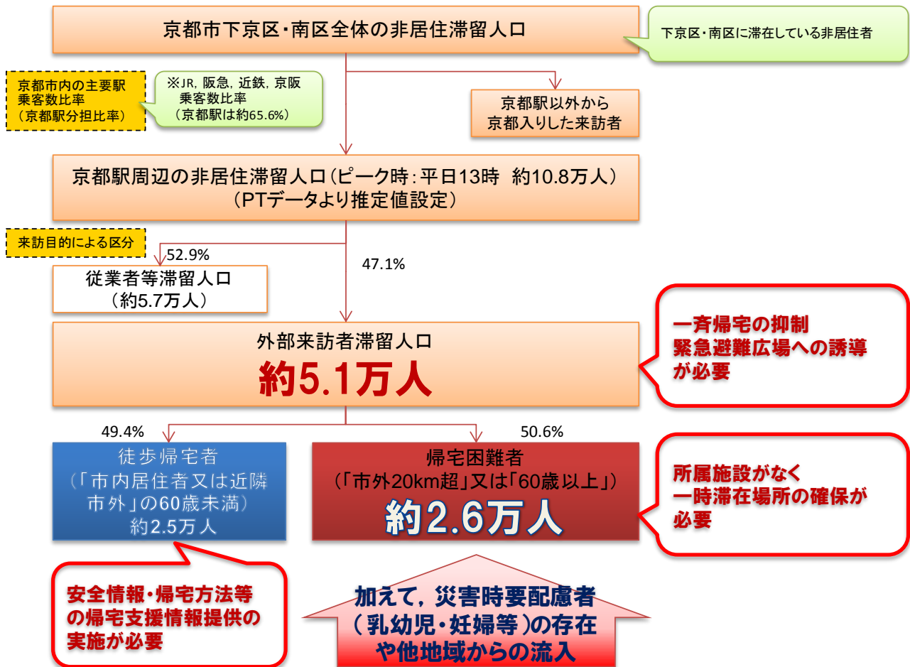
図表 3 退避行動シミュレーションに基づく帰宅困難者数の推計フローと推計結果
