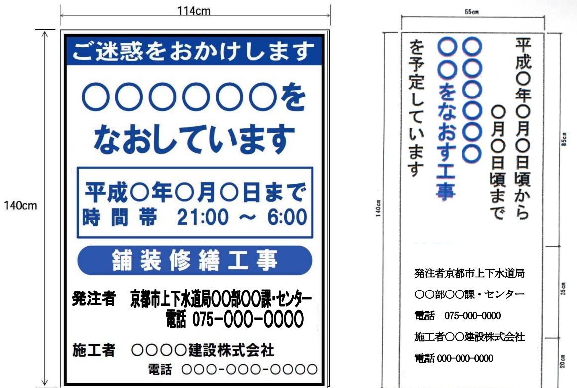
図 1-1-2 工事標示板記載例
