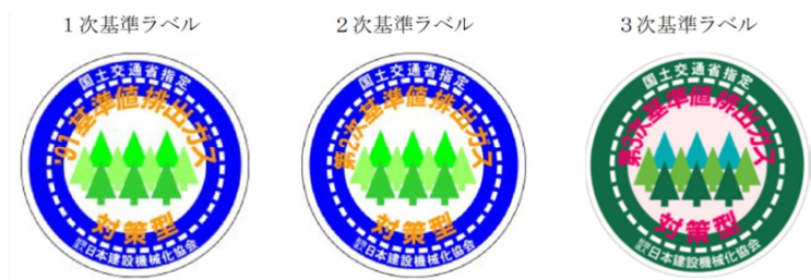
図 1-1-3 排出ガス対策型建設機械指定ラベル（一般工事用）
