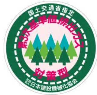
参考図 排出ガス対策型建設機械指定ラベル（一般工事用）
