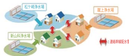
連絡幹線配水管による給水のバックアップ機能の強化イメージ
