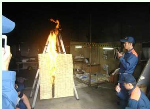
屋外で放火されやすい物品(すだれ等)の着火性と燃焼状況を確認
