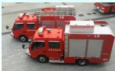
「大規模震災用高度救助車」は、AR(Air Rescue)とER(Electoric Rescue)の2台1組になっており、ARには圧縮空気を利用する器具を中心とした資器材を、ERには電動式器具を中心とした資器材を積載しています。
