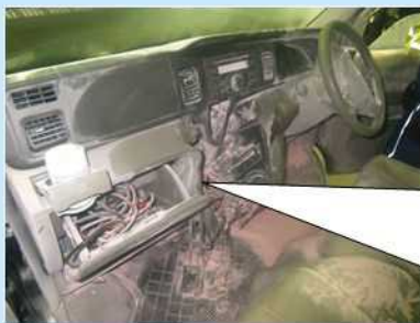
押し込まれ続けたシガーライターが発熱を続けたため、高温となり周囲の可燃物が発火した。
