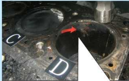
過度のオーバーヒートで発生する現象の1つ、シリンダーの割れ
