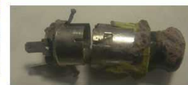
押し込まれ続けたシガーライターが発熱を続けたため、高温となり周囲の可燃物が発火した。
