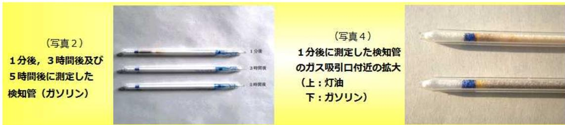
灯油は, 1分後に測定したものは, ガス吸引口から順に, 茶色, 淡ピンク及び淡褐色を示したが, 3時間後に測定したものは, 茶色及び淡褐色のみを示し, 淡ピンクは視認できなかった。5時間後に測定したものは, 検知せず, 色調の変化はなかった。(写真3及び4)
