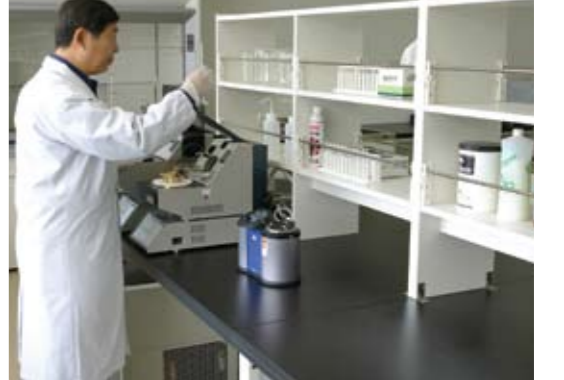
●分析実験室 ガスクロマトグラフィや熱分析装置などの機器を活用して、危険物等の性状判定試験や火災原因の鑑識などを行います。
