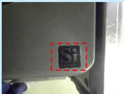
Siセンサーこんろのシンボルマークが貼られたガステーブル
