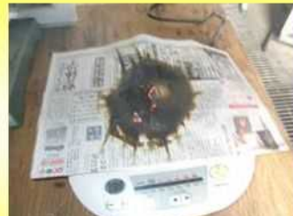
写真6 無炎燃焼から有炎燃焼へ移行した状況
