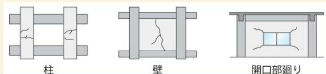
【コンクリートのひび割れ】
