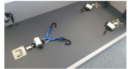
市バス車内の新型車椅子固定ベルト
